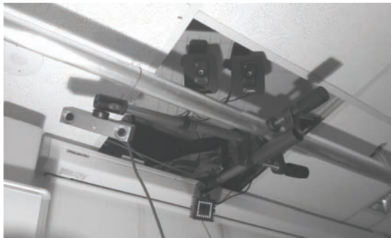
FIGUUR 2 Beginnend links zien we met de klok mee de stereo camera, de twee infra-rood camera's en de time-of-flight camera
